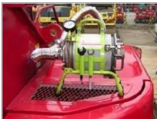
黒煙除去装置状況
